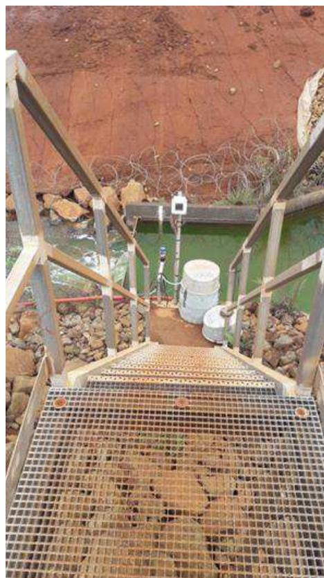
Figure 10 : Préleveur automatique installé sur le drain 4R8
