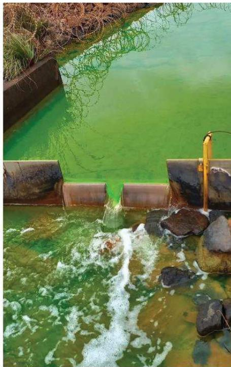
**Figure 11 : Traceur observé au niveau du drain 4R8**
